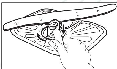
1. Поверните фильтр (A) против часовой стрелки и извлеките его.
